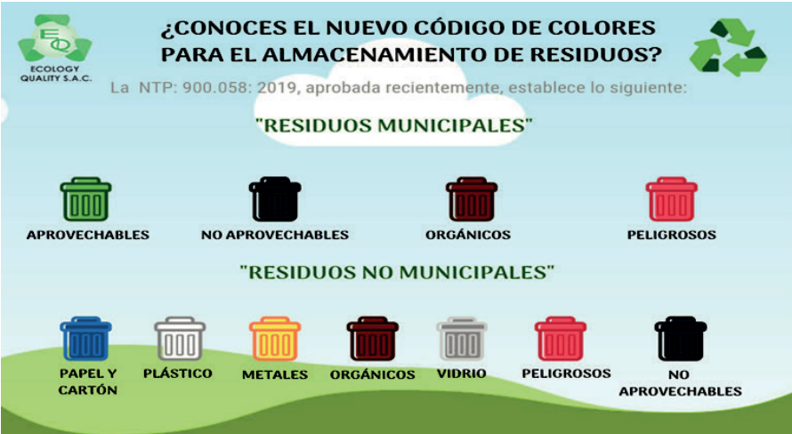
FIGURA 28. Código de colores para el almacenamiento de residuos. Fuente: Instituto Nacional de Calidad (2019).
